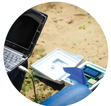
Sur la photo, on voit l'ordinateur relié aux capteurs de sol pour recueillir et stocker les relevés d'humidité directement à partir du champ. L'information sera utilisée pour prendre une décision éclairée en matière d'irrigation.
