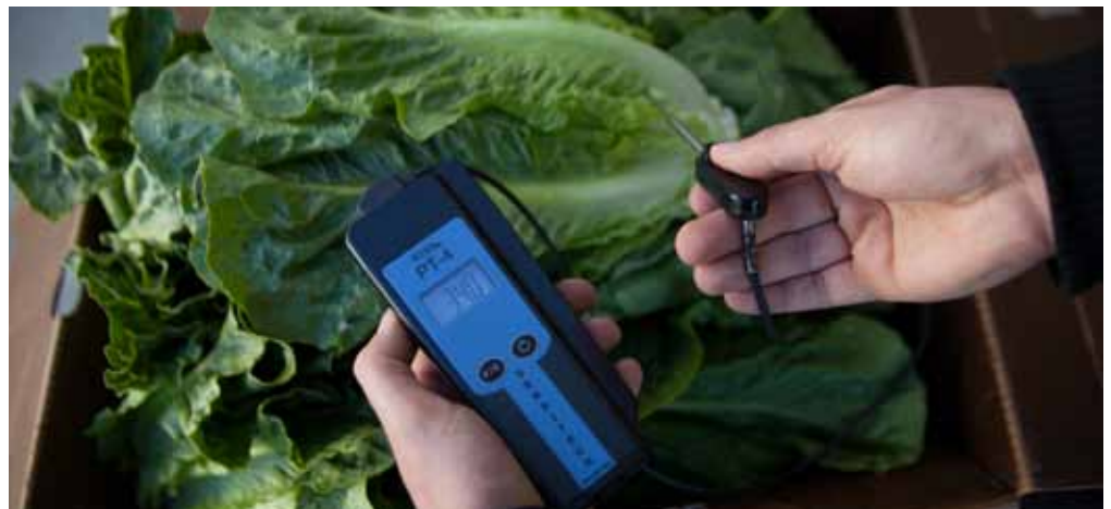
Le personnel de l'établissement surveille la température du produit et supervise le processus de refroidissement pour assurer la sécurité et l'intégrité du produit EW [PP EW IRIVK] IJ½GMIRG]
